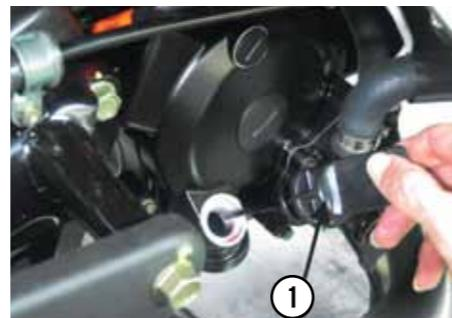
1. Τοποθετήστε το σκούτερ στο κεντρικό σταντ σε επίπεδο έδαφος. Αφαιρέστε το δείκτη λαδιού (1) από το δεξιό καπάκι του κάρτερ.
